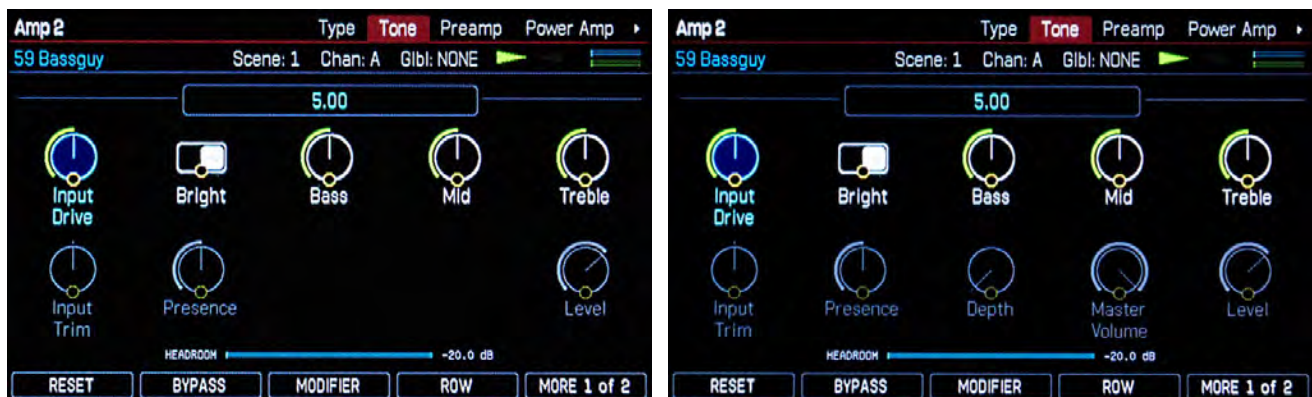
Tone Control Display AUTHENTIC (wie am Verstärker-Vorbild) oder Tone Control Display IDEAL
